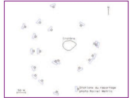
**Figure 5.** Schéma présentant les positions successives de la caméra lors du lever Rollei-Metric.
